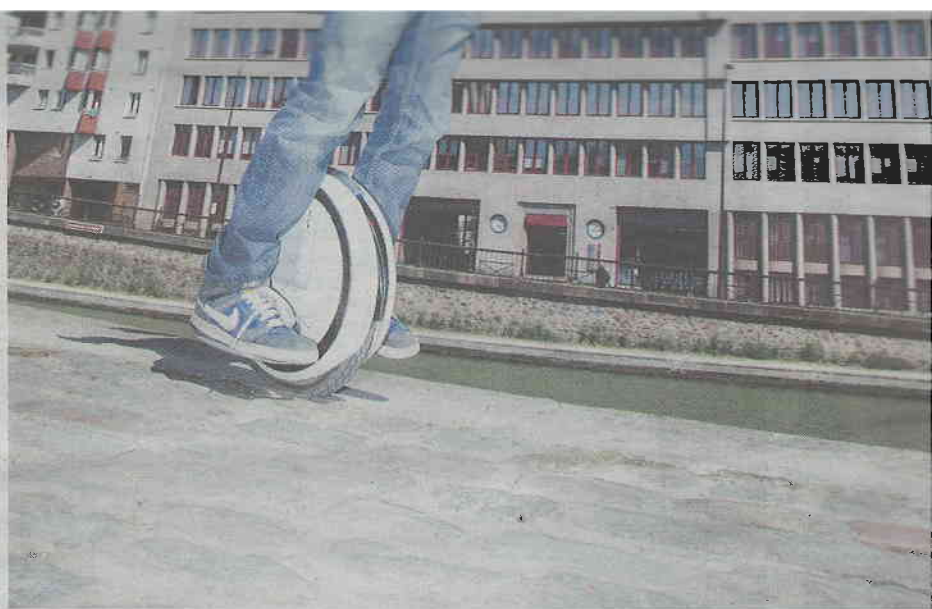
Gyorroue : on s'incline pour accélérer, on se redresse pour ralentir. Ici, Antoine Sébis.
